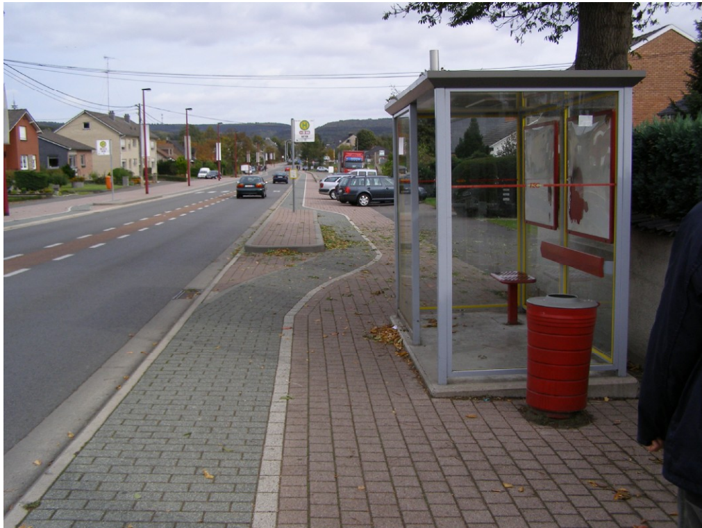
Obr. 2: Pás pro cyklisty s jednosměrným provozem, vedení v prostoru zastávky autobusu, Kelmis, Belgie
