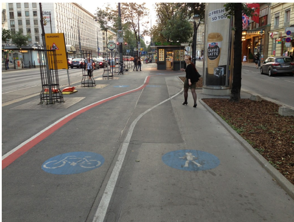
Obr. 4: Pás pro cyklisty s obousměrným provozem v prostoru tramvajové zastávky, Ringstrasse, Vídeň, Rakousko
